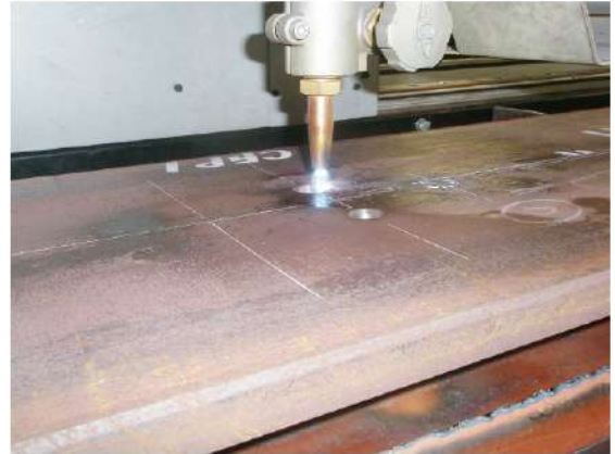
ガス切断ロボットによる柱フランジ長孔の製作
